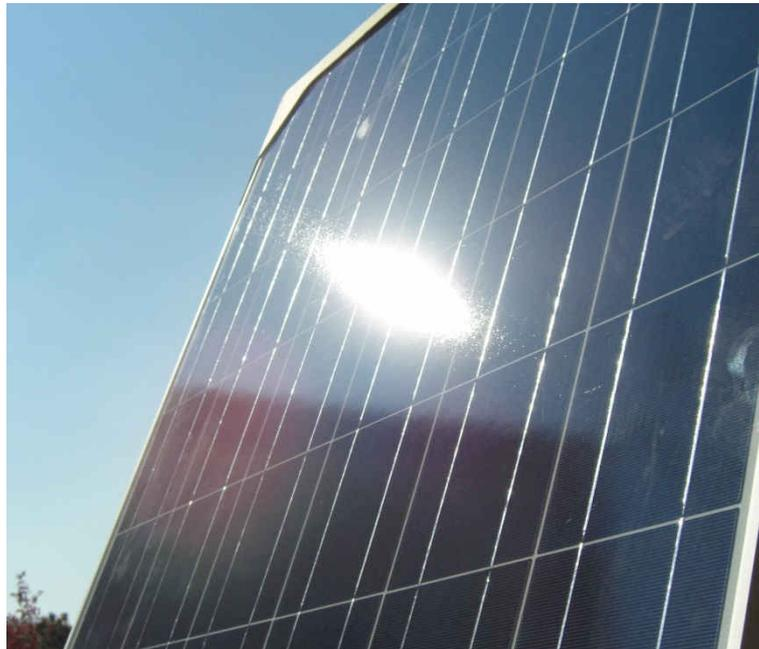
Bündelaufweitung beim Sonnentest eines polykristallinen Moduls,
